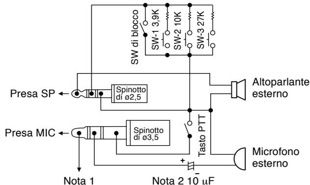
**Nota 1:** Nel ricetrasmittitore, la tensione viene trasmessa lungo la resistenza di  $100\ \Omega$  nella linea a  $3,5\ \text{V}$ . Con una corrente di  $2\ \text{mA}$ , vengono trasmessi circa  $3,3\ \text{V}$ .
