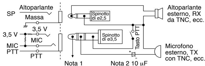
**Nota 1:** Nel ricetrasmittitore, la tensione viene trasmessa lungo la resistenza di  $100\ \Omega$  nella linea a  $3,5\ \text{V}$ . Con una corrente di  $2\ \text{mA}$ , vengono trasmessi circa  $3,3\ \text{V}$ .
